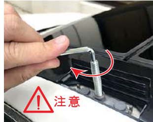
注意 螺絲頂住後，以內六角工具 順時針旋緊加壓約1/4圈
